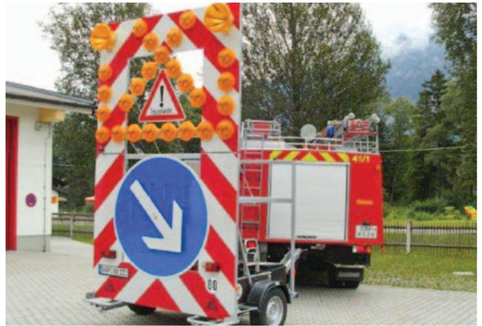
Der Verkehrssicherungsanhänger (Fa. Nissen) dient in erster Linie bei Einsätzen zum Schutz der eigenen Mannschaft sowie der anderen Verkehrsteilnehmer auf 2-spurigen Bundesstraßen sowie insbesondere auf der Autobahn A95. Dieser Anhänger kann mittels Bluetooth-Fernbedienung komplett vom Führerhaus bereits kurz vor der Einsatzstelle bedient werden. Auch dieser Anhänger wurde soweit zulässig in LED-Technik ausgeführt.
