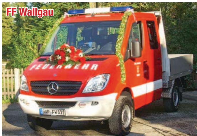
Neu in Dienst gestellt wurde bei der FF Wallgau ein VersorgungslKW (V-LKW): Mercedes Sprinter mit Achleitner Allrad Umbau Perfekt, sechs Mann Besatzung, Lichtmast, Verkehrswarnanlage, zwei Preßluftatmer, Türöffnungswerkzeug, verschiedene Wechselcontainer zum Fahrzeug (Verkehrsabsicherung und Öl, Waldbrand). Den Aufbau hat die Fa. Walser aus Vorarlberg durchgeführt (Ladepritsche und Rückwand sind individuelle Lösungen der Fa. Walser).
